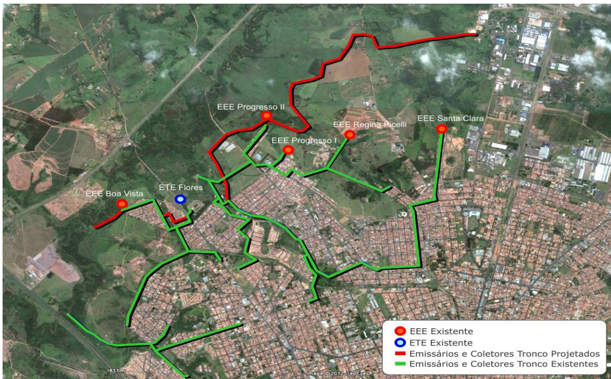
Figura 3.3.161. Redes existentes (em verde e amarelo) e projetadas (em vermelho).
