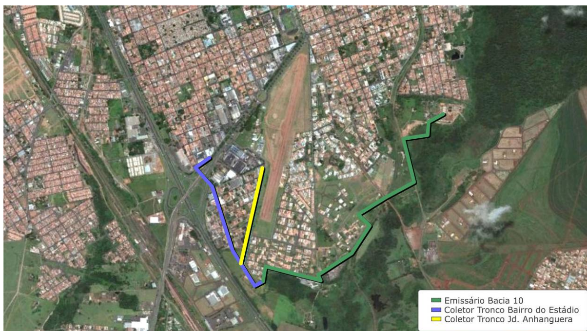
Figura 3.3.148. Vista do Coletor Tronco Anhanguera até encontrar o Emissário Bacia 10
